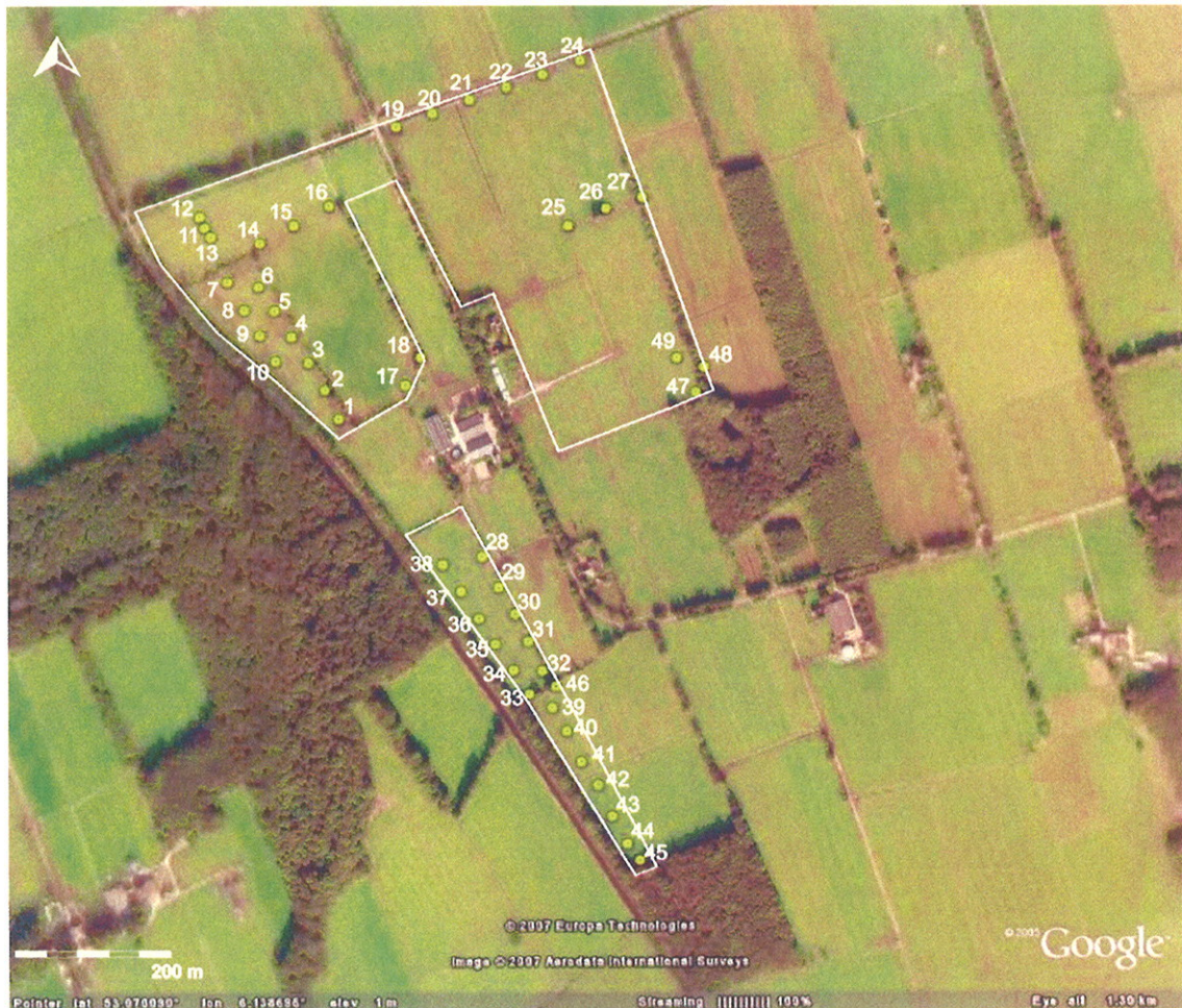
Figuur 5: Ureterp, De Mersken: boorpuntenkaart. De begrenzing van de onderzoekslocatie is aangegeven met een witte lijn. De RD-coördinaten van het plangebied zijn N - 205,306/565,650; O - 205,498/565,229; Z - 205,449/564,623; W - 204,751/565,38. De genummerde gele punten duiden de uitgevoerde boringen aan.
